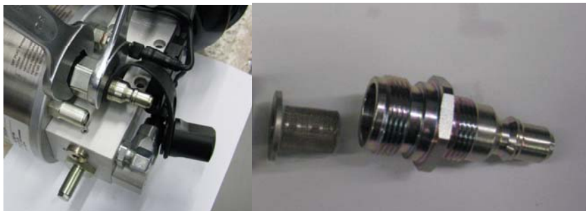
Kuva 4 Kuvassa vasemmalla täyttöhde avataan rungosta (AV 30 ja AV27). Kuvassa oikealla suodin ja täyttöhde
